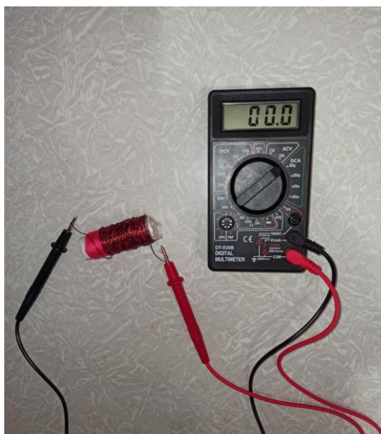
Рисунок А.5 – Під'єднаний мультиметр до котушки
