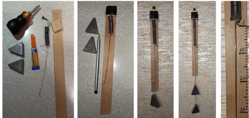
Рисунок 2.21 – Послідовність виготовлення динамометра
