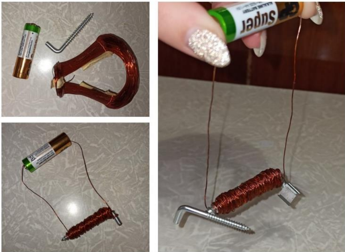
Рисунок 3.1 - Послідовність виготовлення електромагніту
