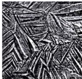
Рис. 12 – Структура мартенситу, \times 1000
