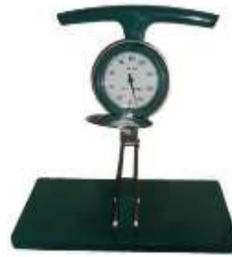
Рисунок 1. Пружинні динамометри: А – ручний динамометр ДПР-120; Б – становий динамометр ДС-200.
