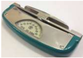
Рисунок 1. Пружинні динамометри: А – ручний динамометр ДПР-120; Б – становий динамометр ДС-200.
