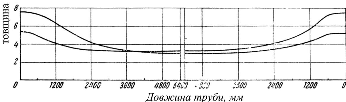
Рисунок 2.23 — Зміна товщини стінки по довжині труби при редукуванні з натягом
