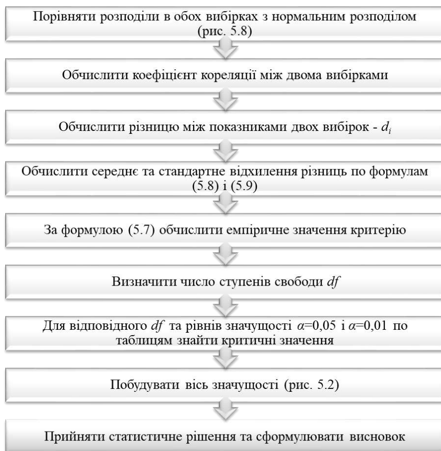
Рис. 5.12 – Алгоритм порівняння середніх за критерієм t -Стюдента (залежні вибірки)
