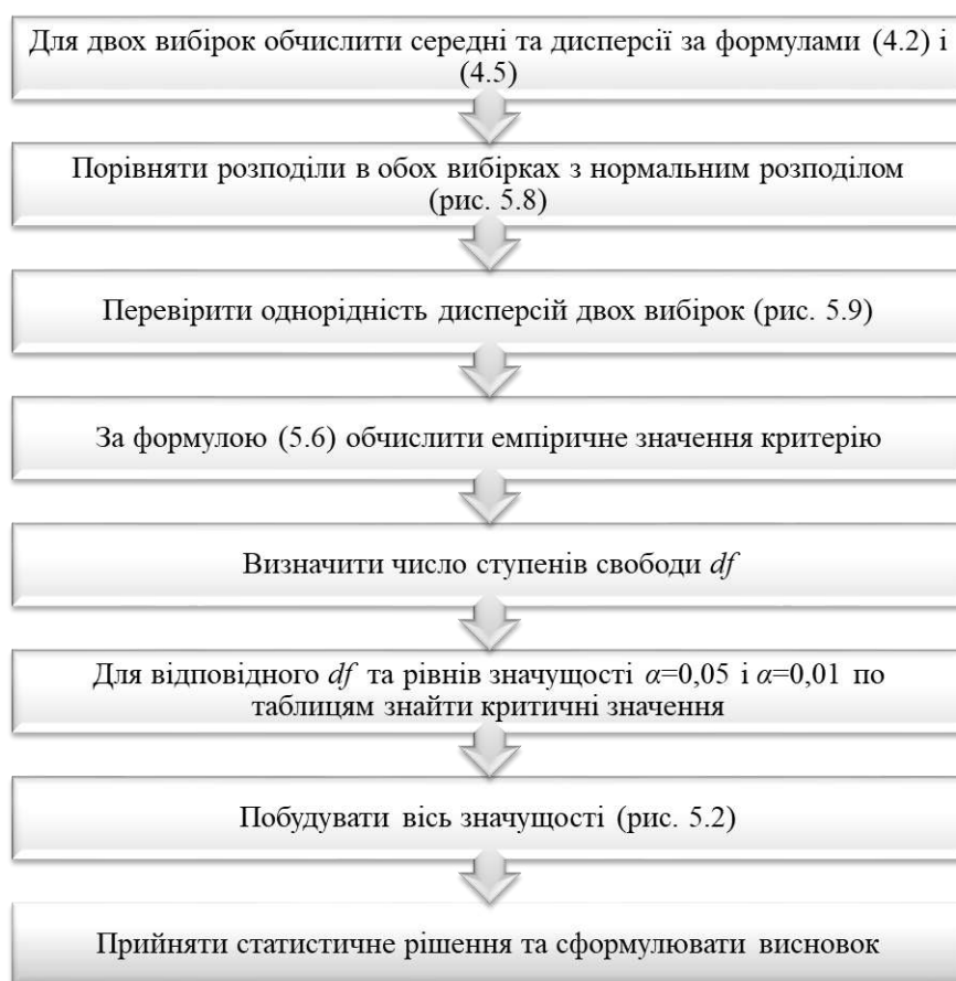
Рис. 5.10 – Алгоритм порівняння середніх за критерієм t -Стюдента (незалежні вибірки)
