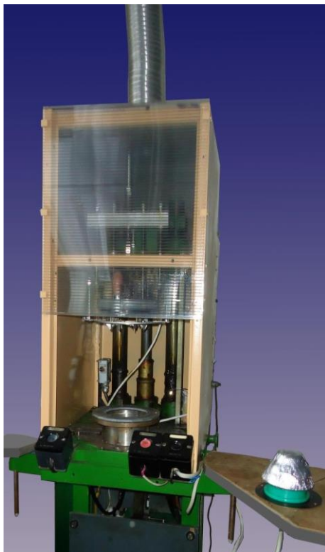
Рисунок 3.9 – Установка термічного формування корпусу півмаски: а – експериментальна установка термічного формування корпусу півмаски, б – корпус півмаски
