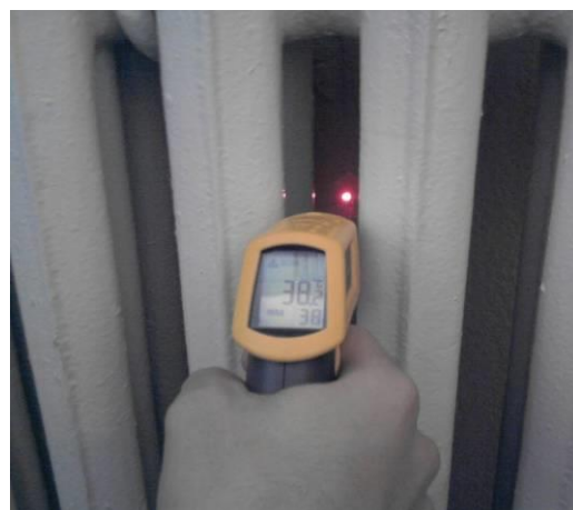
Рис. 3.19. Вимірювання температури пірметром Fluke 62 mini
