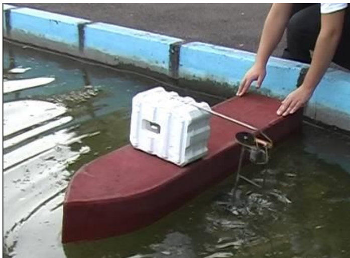
Рис. 2.8. Експериментальне дослідження діючої моделі хвильової енергетичної установки
