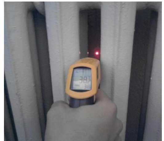
Рис. 3.19. Вимірювання температури пірометром Fluke 62 mini
