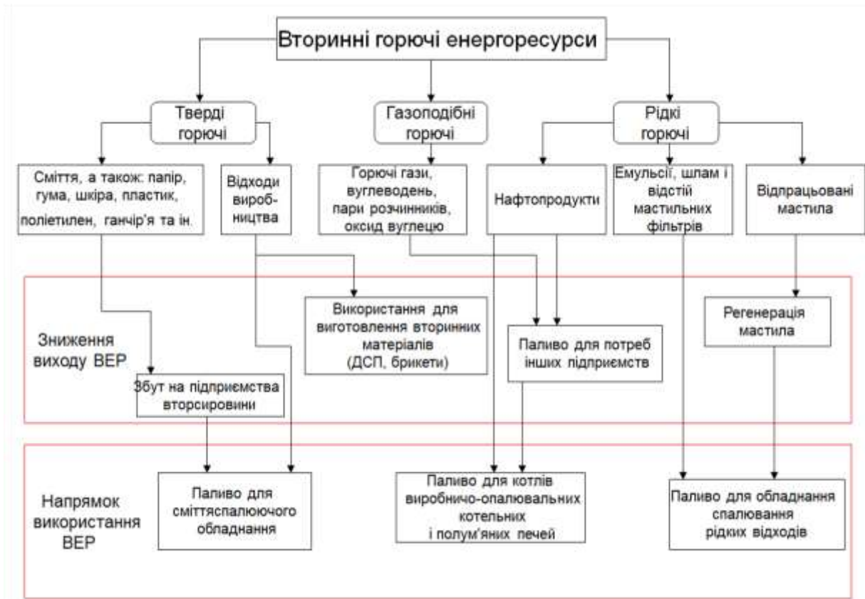
Рисунок 1.1 - Схема комплексного використання паливих ВЕР на підприємствах суднобудівельної галузі
