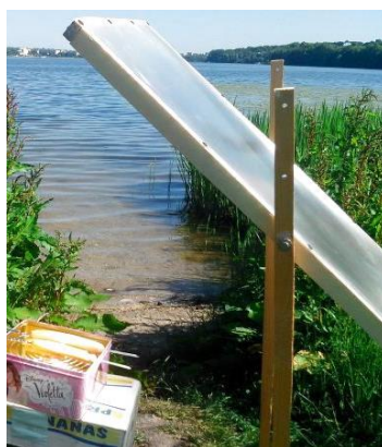
Рис. 1.5. Процес приготування їжі з використанням лінзи Френеля [20].
