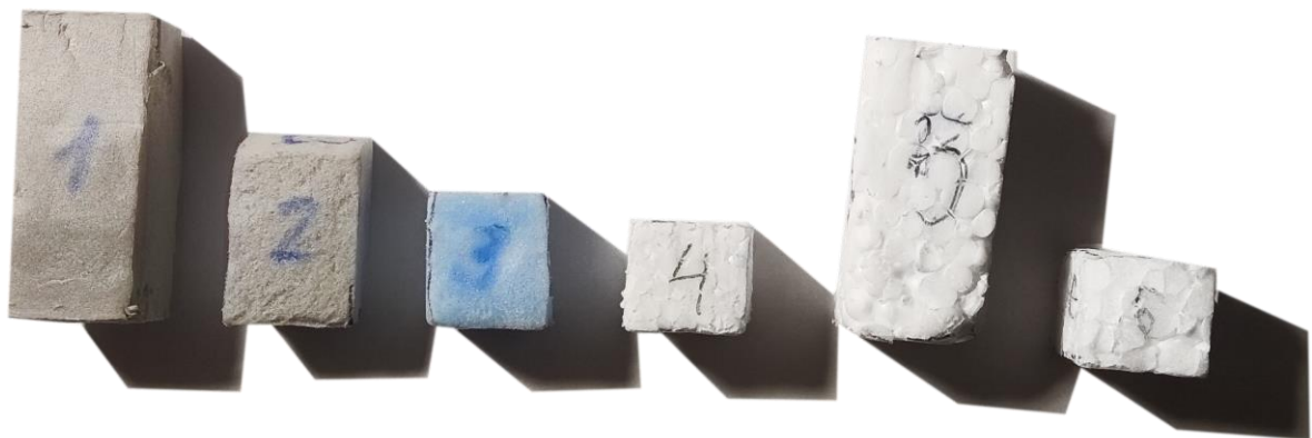
Рис. 3.1 – Зразки плит пінопласту: 1 - 5-тисантиметровий екструдований (Sweetondale), 2 - 3-хсантиметровий екструдований (Styrofoam), 3 - 2-сантиметровий екструдований (Styrofoam), 4 - 2-сантиметровий марки ПСБ-35, 5 - 5-тисантиметровий марки ПСБ-25, 6- 2-сантиметровий марки ПСБ-25.
