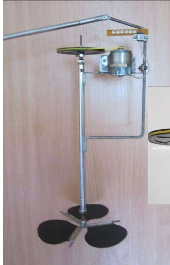
Рис. Фото діючих моделей хвильової енергетичної установки: а) дволопатєва модель; б) удосконалена трилопатєва модель
