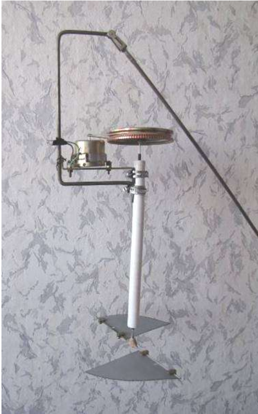
Рис. Фото діючих моделей хвильової енергетичної установки: а) дволопатєва модель; б) удосконалена трилопатєва модель
