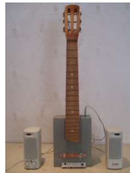
Електрогітара з оптичним звукознімачем
