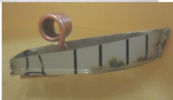
Рис. 4.17. Фото діючих моделей пристрою для демонстрації перетворення теплової енергії в механічну: а) перший варіант моделі; б) удосконалена модель
