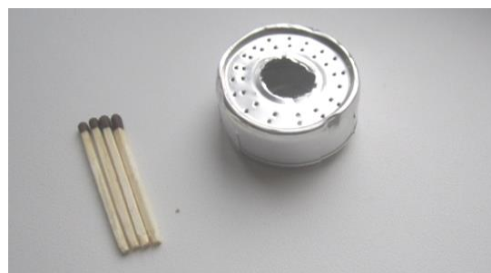
Рис. 4.18. Один із варіантів конструкції робочого циліндра та трубопроводу моделі (а) та можлива конструкція нагрівача, у якому використовується етиловий спирт (б)
