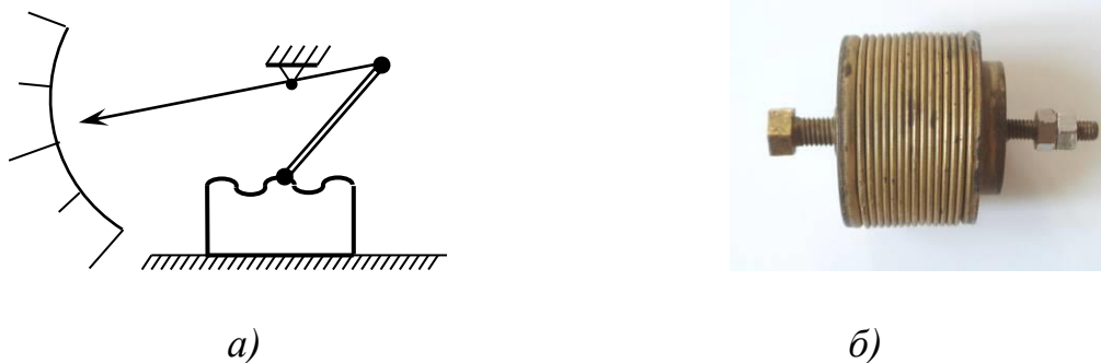
Рис. 5.4. Барометр-анероїд: (а) – схема приладу; (б) – герметична камера барометра
