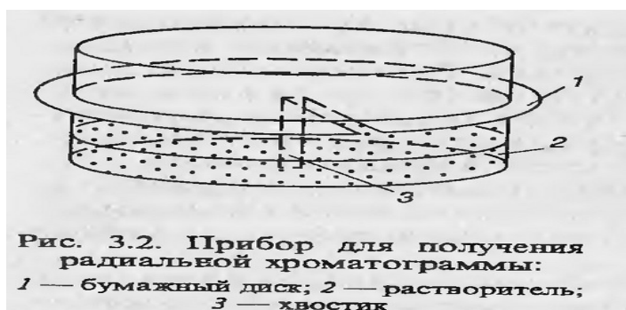
Рисунок 5.1 – Прилад для отримання радіальної хроматограми:
