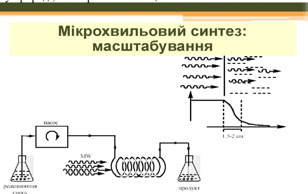
Рисунок 8.1. – Схема мікрохвильового синтезу
