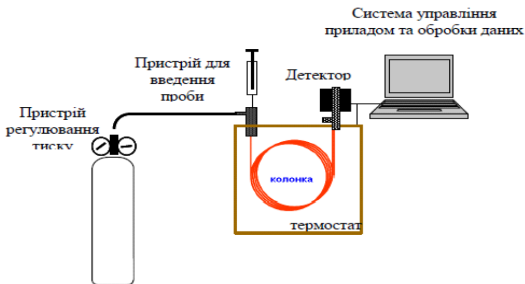
Рис. 1.2. Схема будови газового хроматографа
