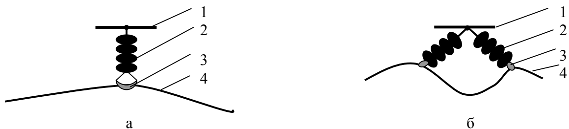
Рис. 1.14. Кріплення провода в фазі на проміжній (а) та анкерній (б) опорах: 1 –траверса; 2– гірлянда ізоляторів; 3– зажим;4– провід
