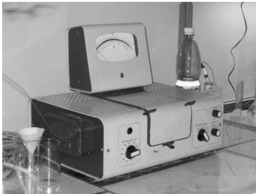
Рисунок 4 – Колориметр фотоелектричний концентраційний КФК-2 (зовнішній вигляд)
