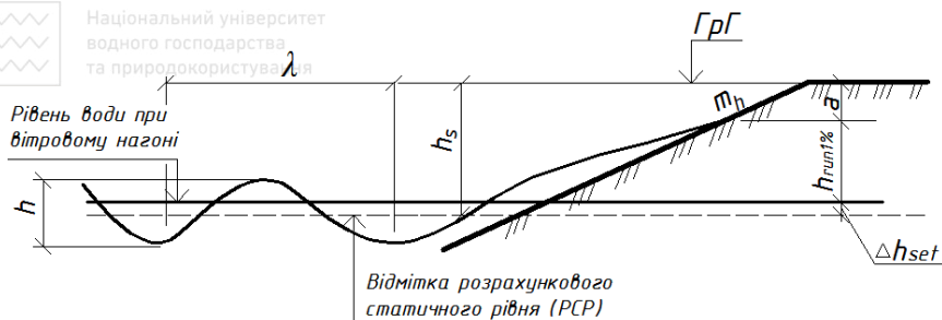
Рис. 1.6. Розрахункова схема для визначення відмітки гребеня греблі та елементи хвиль
