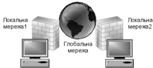
Рис.10.5. Схема використання міжсіткового екрану
