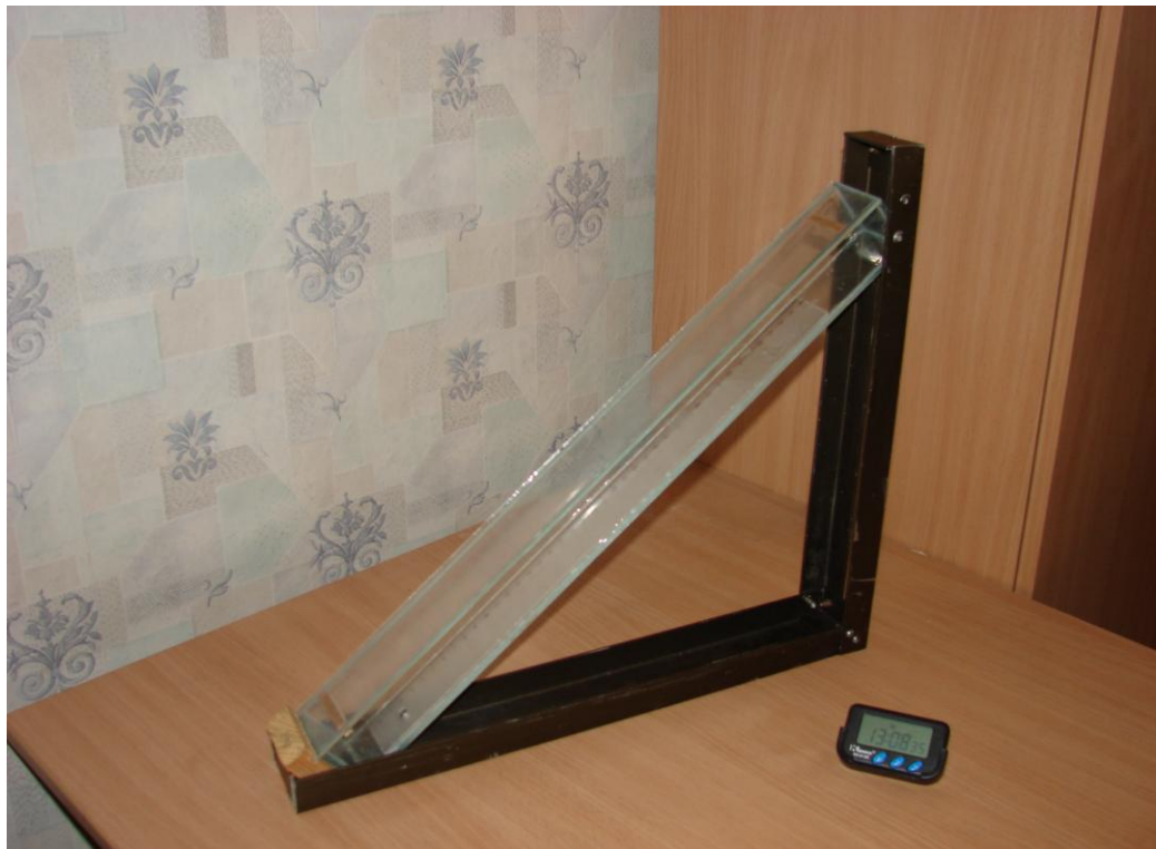
Рис. 3.10. Кліщодром для вивчення швидкості пересування кліщів (виготовлено за А.Н.Алексєвим) [158]
