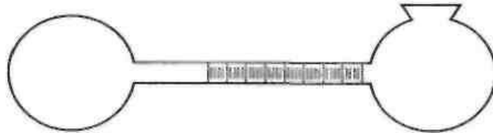
Рис. 1 Прилад конструкції ЛДУ для вивчення процесу набухання об'ємним методом
