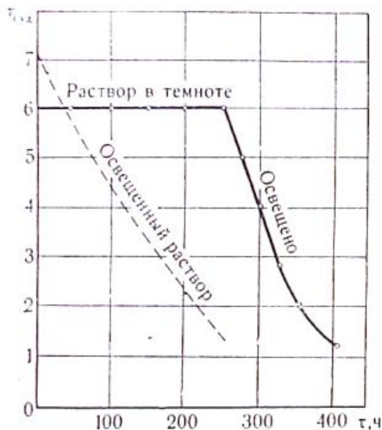
Рис. 5.3. Залежність в'язкості гумового клею на СКВ від часу освітлення
