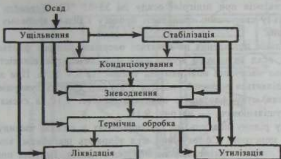
Рис. 9.9. Схема процесів обробки осаду
