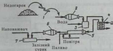
Рис. 13.2. Схема виробництва залізного сурику з недогарка: 1 – сито; 2, 6 – кульові млини; 3 – промивний казан; 4 – сушарка; 5 – випалювальна піч; 7 – змішувач
