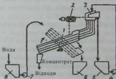
Рис. 12.8. Технологічний комплекс збагачення на шлюзах:
