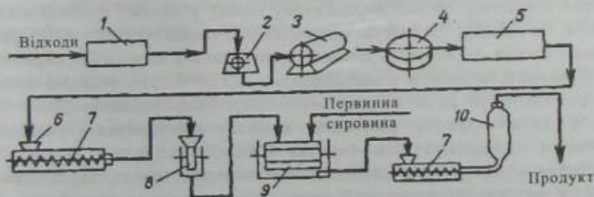
Рис. 14.7. Схема виробництва вторинної поліетиленової плівки:
