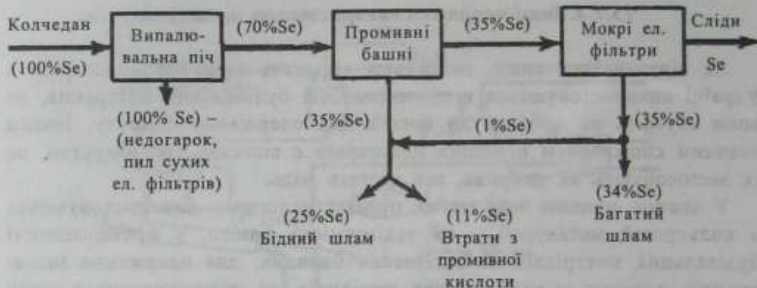
Рис. 13.4. Баланс селену для одного з контактних цехів, обладнаних механічними печами
