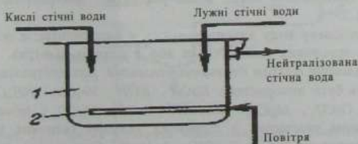
Рис. 11.1. Нейтралізатор змішування: 1 — місткість; 2 — розподільник повітря
