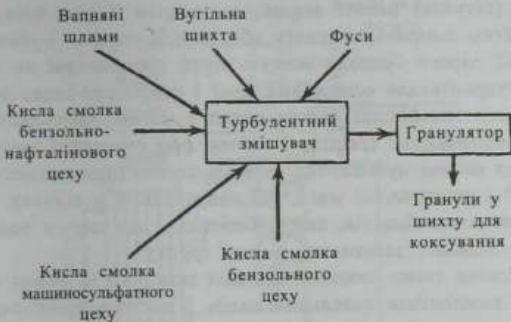
Рис. 14.3. Схема підготовки відходів коксохімічних виробництв при використанні їх у шихті для коксування
