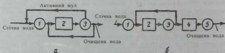
Рис. 9.5. Схеми установок для очищення стічних вод біофільтрами: 1 – одноступінчаста; 6 – двоступінчаста; 7 – первинні відстійники; 2, 4 – біофільтри I і II ступенів; 3 – вторинні відстійники; 5 – третинний відстійник
