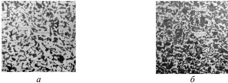
Рис. 8.3. Змішана поліедрична мікроструктура: а – перліт, 0,3% С; б – світле поле – феррит, темне поле – перліт, 0,4% С.
