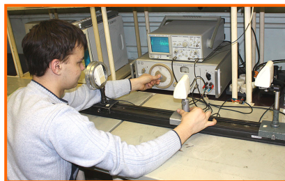
Рис. 2.31. Стенд лабораторної роботи "Визначення швидкості звуку в повітрі"
