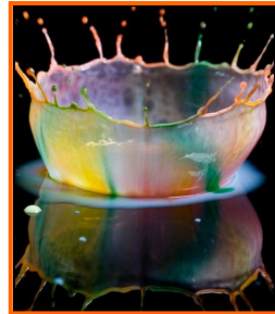
Рис. 2. Надшвидкісна фотографія розльоту рідини після падіння краплі
