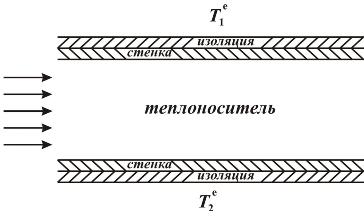
Изолятор – минеральная вата (толщина 70 мм)
