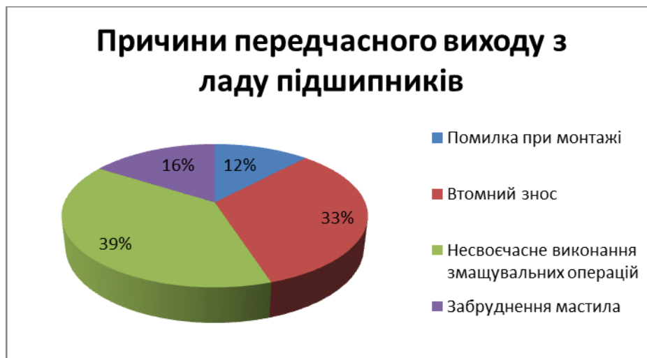
Рисунок 1 – Узагальнення причин передчасного виходу підшипників з ладу
