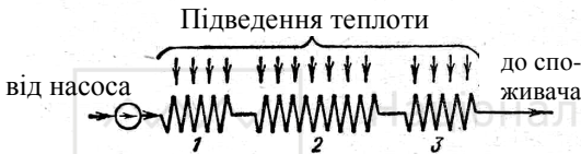
Рис. 18.8. Схема руху робочого тіла по одновитковим трубам прямоточного котла
