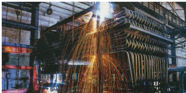
Рис. 3.7. Виготовлення блоків конвективного перегрівника
