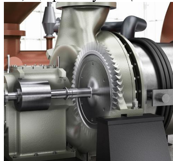
Рис. 14.11. Одноступенева турбіна, яка працює на парі органічних сполук (Siemens)
