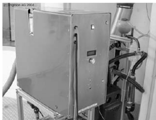
Рис. 14.22. Паровий двигун електричною потужністю - 4,6 кВт та електричним ККД 17%, SteamCell (Enginon, Німеччина)
