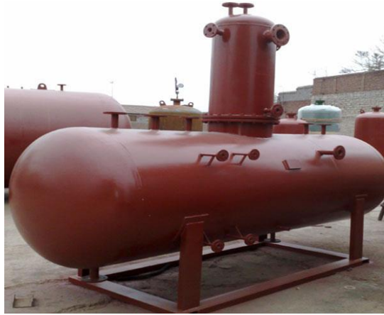
Рис. 6.11. Зовнішній вигляд деаератора.
