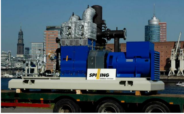
Рис. 14.23. Електростанція на лісопилці (Австралія) з котлом для спалювання деревини Ел. потужність: 425 kWel Гостра пара: 5,5 t/h / 34 bar / насичена. Тиск вихідної пари: 1,0 bar
