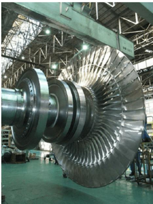
Рис. 5.17. Зовнішній вигляд лопаток висотою 127 см (50 дюймів).
