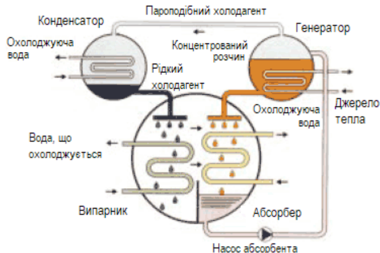
Рис. 15.5. Спрощений цикл АБХМ (Thermax).
