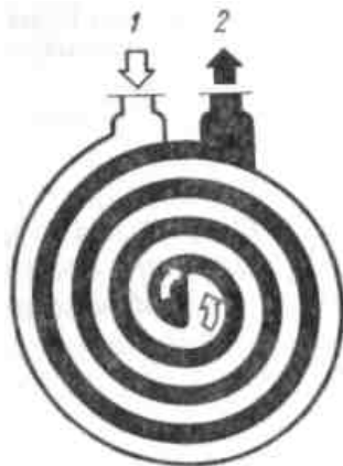
Рис. 7.3 Схема спірального теплообмінника фірми «Альфа-Лаваль»: 1 – подача осаду; 2 – відведення відпрацьованого теплоносія.
