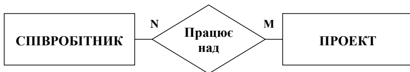
Рис. 4.4. Діаграма «сутність-зв'язок» для прикладу співробітників, що беруть участь у роботі над проектами
