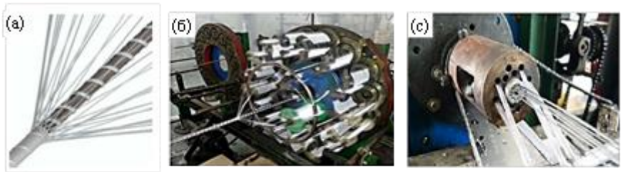
Рисунок 1. Процес отримання стержнів гібридної арматури. а) – вигляд процесу обплетання сталевому арматурному стержню, б) – процес пултрузії під час обплетання стержня; с) – процес пултрузії під час обплетання пучка сталевих арматурних дротів.
