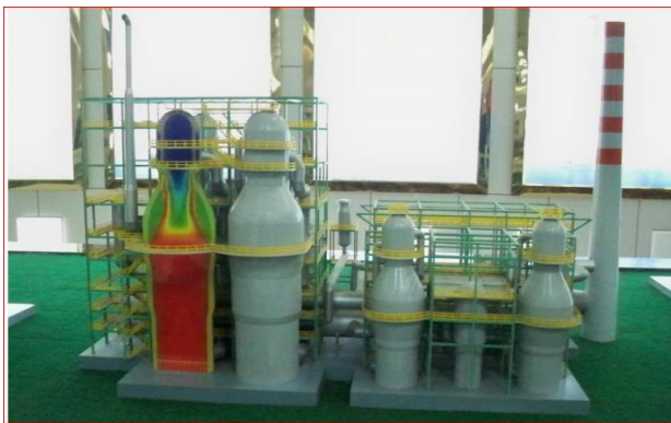
Рис. 3. ДП объем 3200 куб м, 32 фурмы, 4 летки, 4 ВН «Калугин», 200 кг/т ПУТ, Shagang Group (частная фирма)
