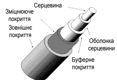
Рис 3.8 Загальний вигляд типового оптичного кабелю.
