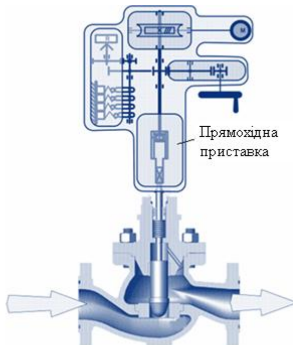
Рисунок 4.30 – Прямохідний виконавчий механізм з регулювальним органом
