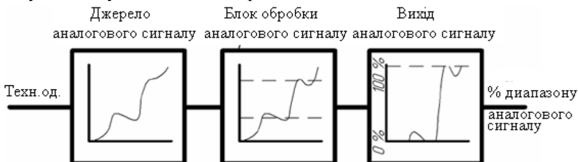
Рисунок 5.32 – Робота блока аналогового виводу в режимі ретрансмісії
