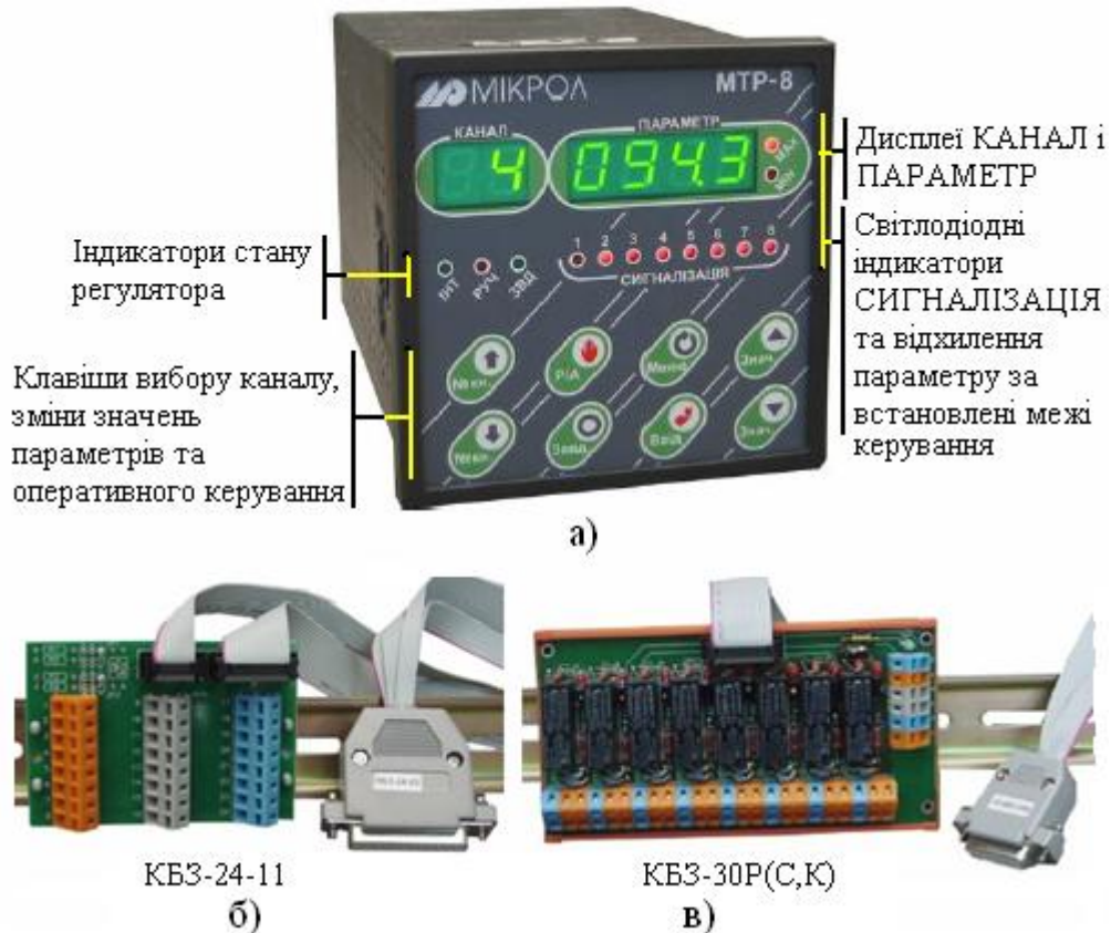
Рисунок 5.29 – Регулятор МТР – 8 (а) і клемно-блокові з'єднувачі для приєднання до базової моделі аналогових входних/вихідних сигналів (б), інтерфейсу та дискретних навантажень (в)
