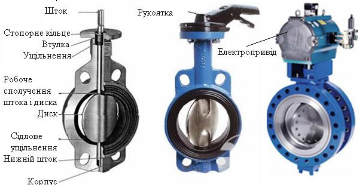
Рисунок 4.15– Конструкція і зовнішній вигляд поворотного затвора типу «Батерфляй»
