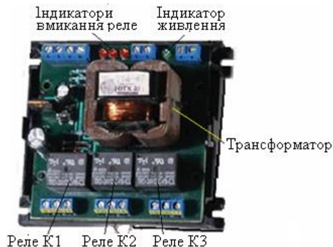
Рисунок 6.19 – Блок живлення і реле БПР
