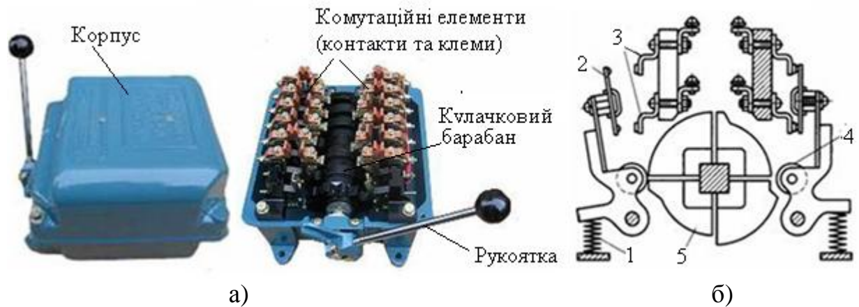
пружина; 2- містковий контакт; 3- нерухомі контакти; 4- важіль; 5- кулачок. Рисунок 3.14 – Командоконтролер змінного струму серії ККТ-60А та будова його котактної групи
