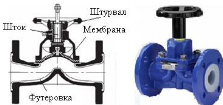
Рисунок 4.16– Конструкція і зовнішній вигляд діафрагмового (мембранного) регулювального органа
