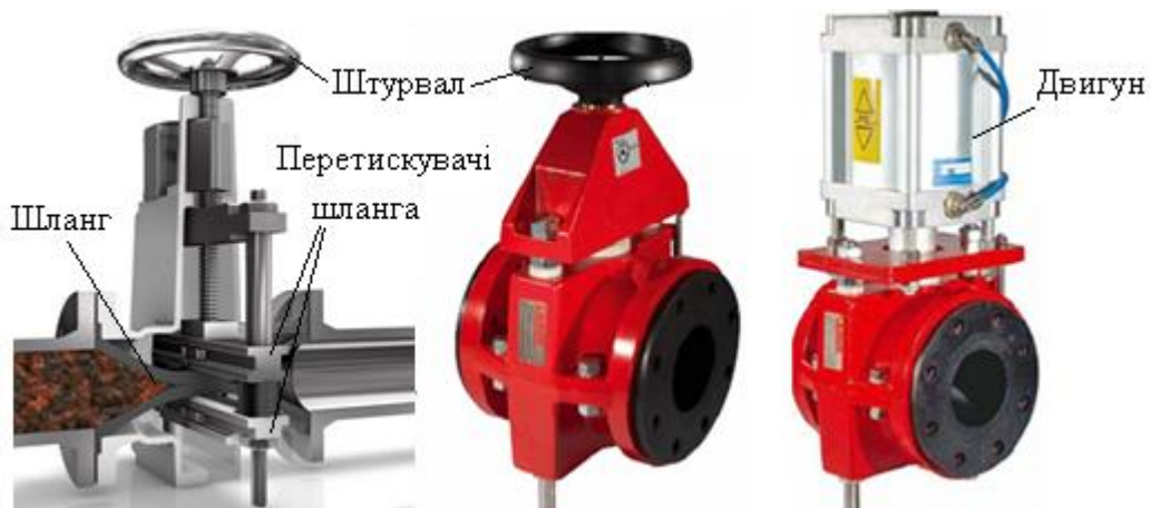
Рисунок 4.17 – Загальна конструкція і зовнішній вигляд шлангової засувки Flowrox
