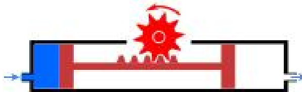
Рисунок 4.37 – Повертальний поршковий механізм з рєчнозубчатою передачею
