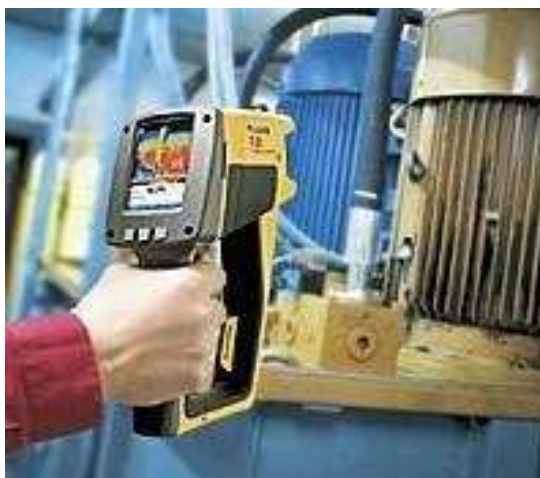
Рис. 12.2. Процес обстеження тепловізором працюючого агрегату
