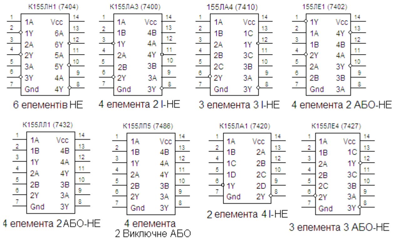
Рисунок 2.8 – Мікросхеми ТТЛ 155 серії
