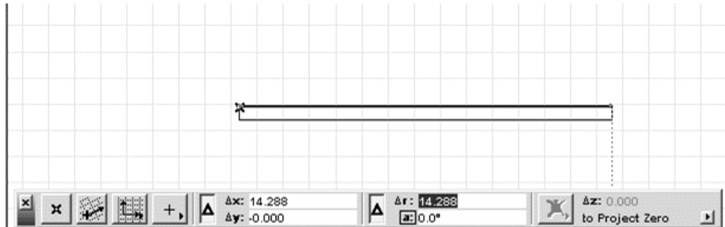
Малюнок 3.2.7 – Побудова стіни за допомогою r - довжини
