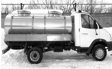
Рис. 46. Автоцистерни для перевезення плідників, молоді чи різновікових особин риб на близькій відстані
