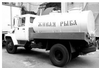
Рис. 46. Автоцистерни для перевезення плідників, молоді чи різновікових особин риб на близькій відстані
