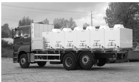
Рис. 45. Автомобіль, обладнаний для транспортування живої риби (молоді і плідників) та його обладнання
