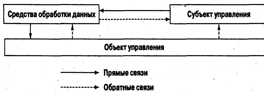
Рис. 17.1. Обобщенная схема связей в современной системе управления, использующей информационные технологии
