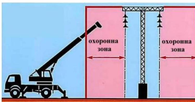
Рис. 1.9. Охоронна зона поблизу повітряних ліній електропередач
