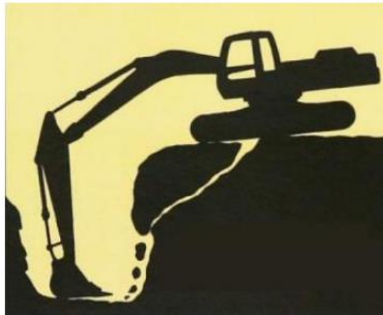
Рис. 1.6. Небезпечна зона поблизу виїмок (котлованів, траншей) з незакріпленими укосами
