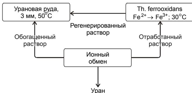
Рис. 5.5. Схема выщелачивания урановой руды (по J. Johnson, 1985).
