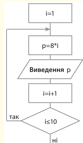
Рис. 2. Фрагмент графічної схеми циклічного алгоритму
