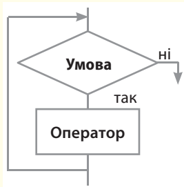
Рис. 7. Графічна схема циклу з передумовою
