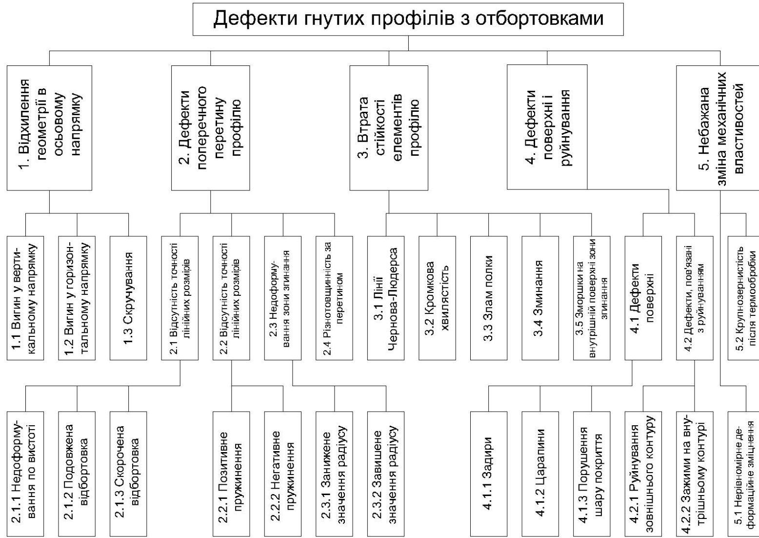
Рисунок 1.14 – Класифікація дефектів профілів з периферійними елементами жорсткості
