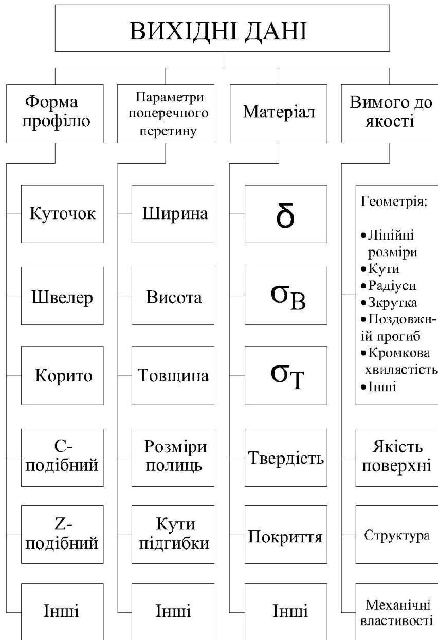
Рисунок 2.1 – Вихідні данні профілю для аналізу технологічності
