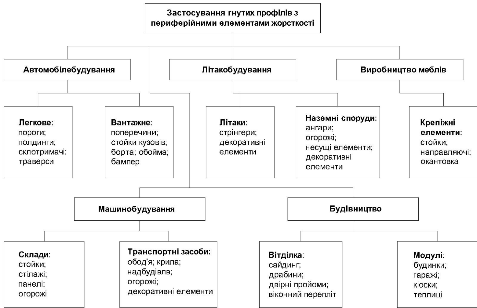
Рисунок 1.1 – Узагальнююча схема застосування гнутих профілів із периферійними елементами жорсткості
