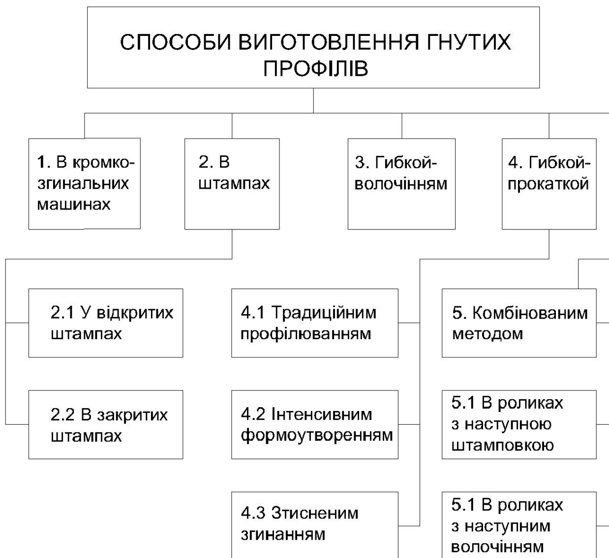
Рисунок 1.3 – Класифікатор методів виготовлення гнутих профілів
