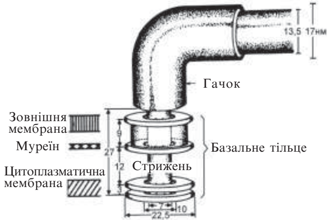
Рис. 2.12. Схема джгутикового апарата у Escherichia coli (за Torley & Wilson's Principles of bacteriology, virology and immunity, 1990)
