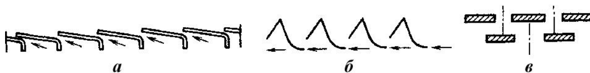
Рисунок 4.14 – Схеми безплавальних газорозподільних ґрат:
