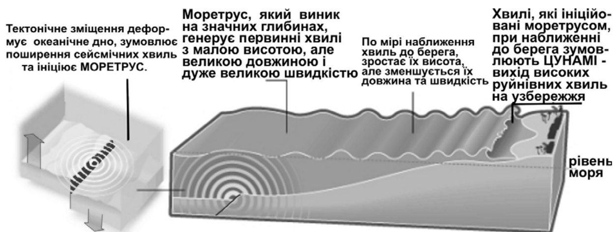
Рис.28. Схема виникнення моретрусу та цунамі.
