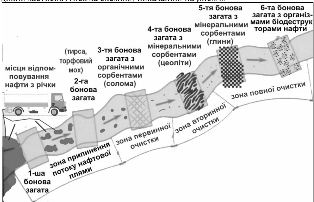
Рис.36. Схема послідовної очистки річки, акваторія якої забруднена нафтою.
