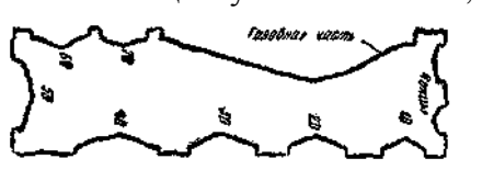
Рис. 96. Шаблон для проверки выпуклости блёсны.
