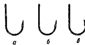
Рис. 6. Формы загиба жала: а — прямое, б — отогнутое наружу, в — загнутое внутрь.
