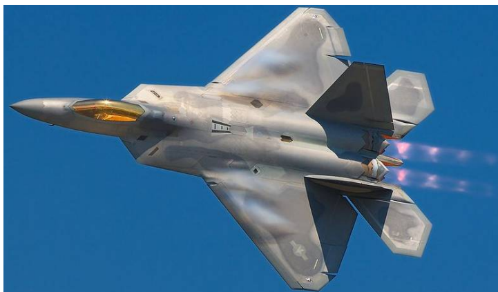
Рисунок 6.39 – Винищувач США 5-го покоління F-22 «Raptor»: розмах крила – 13,56 м; довжина – 18,9 м; висота – 5,09 м; макс. маса – 38 т; навантаження – 10,37 т; тяга 2-х двигунів – 15876 кгс; макс. швидкість – 2400 км/год; макс. безфорсажна швидкість – 1800 км/год; дальність польоту – 5700 км; стеля – 19,2 км; дальність виявлення аеродинамічної цілі – до 300 км
