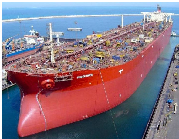
Рисунок 4.11 – Супертанкер Knock Nevis: довжина – 458 м; ширина – 69 м; вантажомісткість – 564 763 т; потужність силової установки – 50000 к. с.
