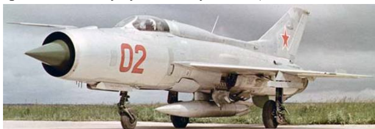
Рисунок 6.35 – Радянський винищувач МіГ-21: макс. швидкість – 2125 км/год; дальність польоту – 1900 км; стеля – 19 км; швидкопідйомність – 13500 м/хв; злітна маса – 8625 кг; тяга двигуна – 3880 кгс; тяга форсажна – 5740 кгс; озброєння: 2 гармати калібру 30 мм; маса ракет (бомб) – 1300 кг
