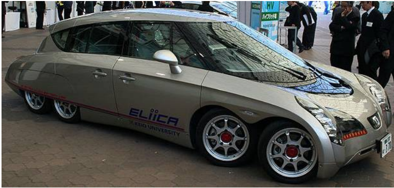
Рисунок 5.51 – Elica (Electric Lithium-Ion Car) - прототип електромобіля, створений в університеті Токіо: швидкість – до 370 км/год; розгін до 100 км/год – за 4,1 с; дальність пробігу – до 370 км; потужність 8 електродвигунів – 480 кВт (640 к. с.); маса – 2400 кг; вартість – $255000
