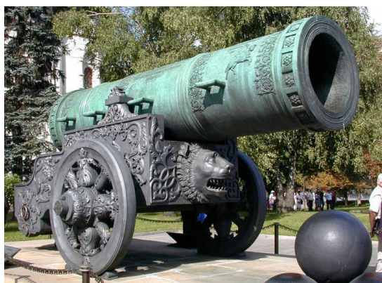
Рисунок 7.6 – Цар-пушка: калібр – 890 мм; довжина – 5,34 м; маса – 39,31 т; маса ядра 2 т; маса заряду 480 кг
