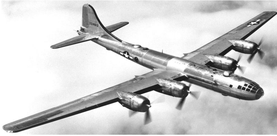
Рисунок 6.30 – Американський стратегічний бомбардувальник В-29 «Superfortress»: екіпаж – 11 чол.; максимальна швидкість – 574 км/год; дальність польоту – 9000 км; стеля – 12 км; двигуни – 4 × 2200 к. с.; озброєння: 12 кулеметів 12,7 мм, 1 гармата 20 мм, бомбове навантаження – 9 т
