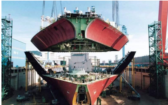
Рисунок 4.12 – Використання блоково-модульного методу складання кораблів
