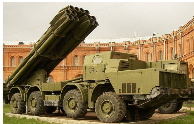
Рисунок 7.18 – Радянська реактивна установка залпового вогню 9А52-2 «Смерч»: калібр – 300 мм; дальність стрільби – до 90 км; кількість напрямних – 12; площа ураження – 672000 м 2
