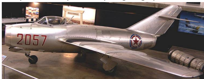
Рисунок 6.33 – Радянський винищувач МіГ-15: максимальна швидкість – 1076 км/год; дальність польоту – 2520 км; стеія – 15,5 км; швидкопідйомність: 3000 м/хв; довжина – 10,1 м, розмах крила – 10,08 м; злітна маса – 6,1 т; тяга двигуна – 2700 кгс; озброєння: 1 гармата 37 мм, 2 гармати 23 мм
