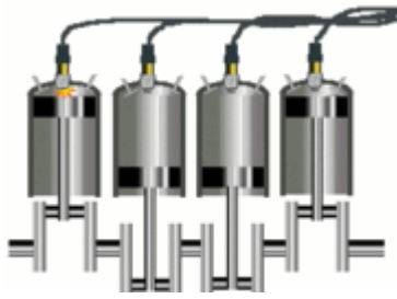
Рисунок 2.23 – Схема роботи рядного чотирициліндрового ДВЗ
