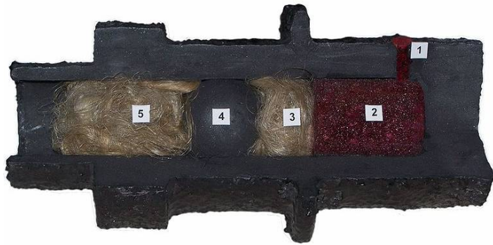
Рисунок 7.20 – Заряд стародавньої пищалі: 1 – запальний отвір; 2 – пороховий заряд; 3 – ущільнювальний пиж (клоччя); 4 – куля; 5 – фіксуєчий пиж
