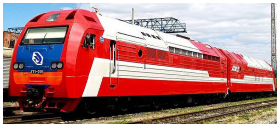
Рисунок 2.34 – Найпотужніший газотурбовоз світу – російський ГТ1: потужність – 8300 кВт; швидкість – до 100 км/год
