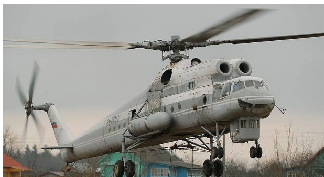
Рисунок 6.49 – Радянський вертоліт Мі-10: екіпаж – 5 чол.; діаметр несучого гвинта – 35 м; довжина – 41,89 м; маса порожнього – 27,3 т; навантаження – до 12 т; макс. швидкість – 180 км/ч; стеля – 2,5 км; дальність – 310 км
