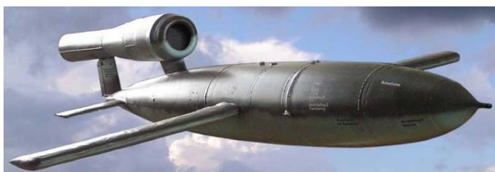
Рисунок 6.24 – Німецька крилата ракета Фау-1: довжина – 7,90 м; розмах крил – 5,37 м; висота – 1,42 м; маса – 2,15 т; двигун – пульсуючий прямоточний з тягою 2,9 кН; швидкість – 656 км/год; дальність польоту – 240 км; стеля – 3050 м; маса бойової частини – 830 кг
