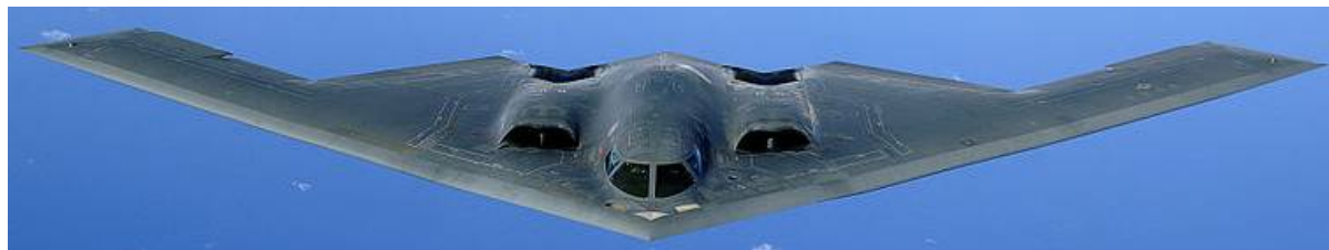
Рисунок 6.38 – Стратегічний бомбардувальник США В-2 «Спірит»: виготовлено 21 літак; вартість одного літака – $2,1 млрд.; довжина – 20,9 м; висота – 5,1 м; розмах крила – 52,12 м; екіпаж – 2 чол.; злітна маса – 171 т; навантаження до 27 т; двигуни – 4 × 1925 кгс; максимальна швидкість – 972 км/год; дальність польоту 11100 км; стеля – 15 км
