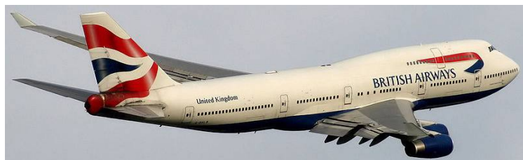
Рисунок 6.42 – Boeing-747 (США): пасажиромісткість – 452 чол; довжина – 70,6 м; розмах крила – 59,6 м; висота – 19,3; швидкість – 955 км/год; дальність – 9800 км
