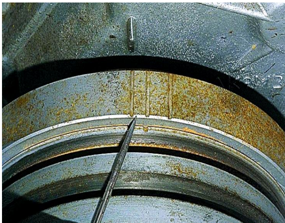
Рис. 8. Положення міток при встановленні поршня першого циліндра в верхню мертву точку.
